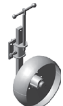
Mecanismul roții posteroare P33 06.000-05 M=61,3 kg
