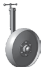
Mecanismul roții anterioare P33 08.000-03 M=94 kg
