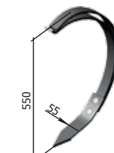
Consolă КПЦ-190 с лапой РК-7 M=4,89 kg
